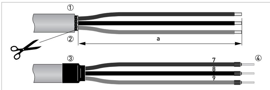
Рисунок 4-12: Подготовка кабеля обмотки возбуждения С для подключения к первичному преобразователю
